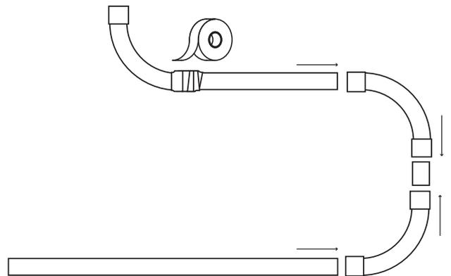
UNISCI I TUBI E LE CURVE E FERMAI CON DEL NASTRO ISOLANTE
